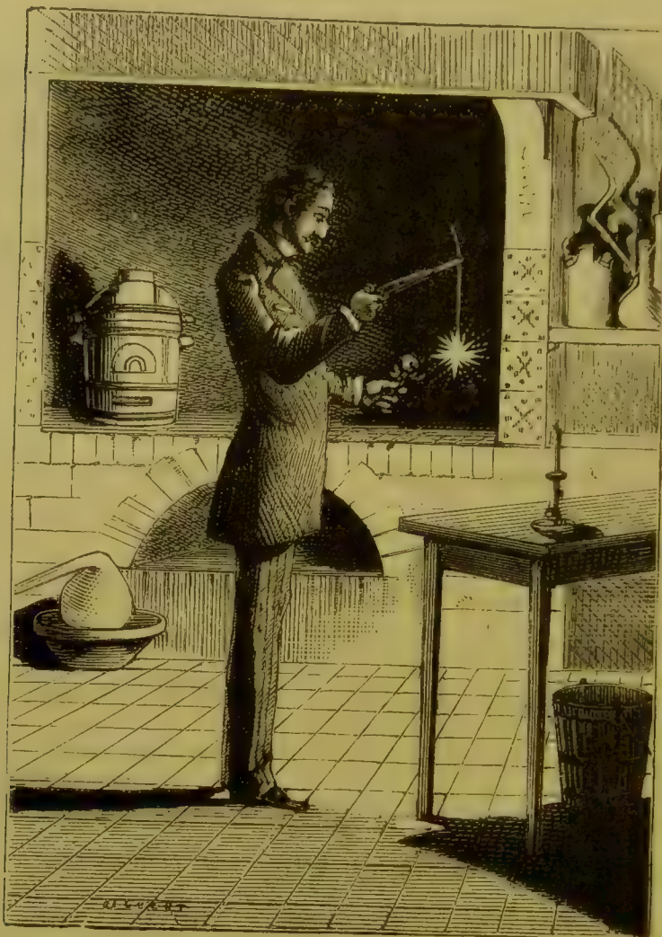
Fig. 218. Fiore artificiale spalmato di una polvere fosforescente, esposto alla luce del magnesio.
